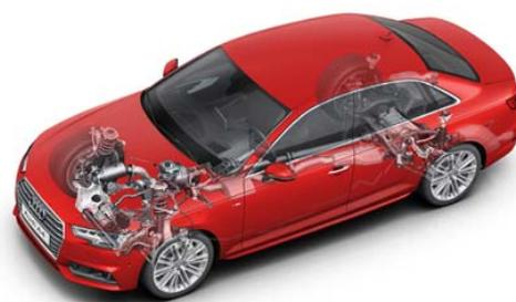
今回さらなる進化を遂げた「ホイールセレクトティブ トルクコントロール」は、そのメカニカルなドライブトレインを補足するシステムのひとつであり、いまやすべての路面状況で機能を果たすようになりました。高速コーナリングにおいては、そのソフトウェア機能が、ホイールスピンの発生を予見して、コーナーに対して内側にある車輪（FWD モデルの場合は前輪、quattro モデルでは前後輪）に軽くブレーキをかけます。こうした制御は、ドライバーがアクセルペダルを踏んでいない場合でも行なわれ、その結果、左右不均等な力のかかり方により、クルマはコーナー内側に向けて若干姿勢を変えるようになります。また、ロールステアの影響がより長い時間ニュートラルを保つようになり、ハンドリングはより正確で、安定したものになります。
