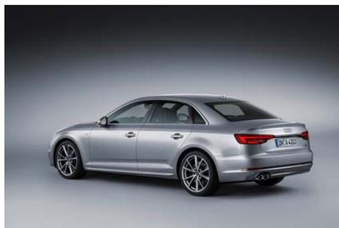
ヘッドライト同様、3D の多面構造を採用したテールランプは、内側の下方コーナー部分が深く落ち込んだ特殊な形状になっています。それぞれのライトユニットに LED が内蔵されています（LED ヘッドライト搭載モデル）。ブレーキライトは、ライトユニットの外側下方に置かれており、ダイナミックブレーキライトが、ユニット上端のストリップを構成しています。
