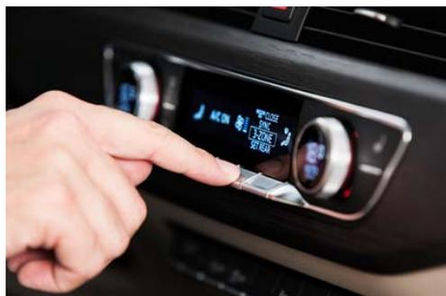
にフレキシブルな制御により、エネルギー消費を最小にしつつ、高いエアクオリティを実現しています。フレッシュエア導入、リサーキュレーティング、どちらのモードでも、活性炭フィルターの働きで、最少のパーティキュレイトまで捕捉する一方で、幅広い帯状をした新しいエアイベントにより、循環するエアボリュームを増やしなが、静かで乗員に直接風をあてないベンチレーションを可能にしています。室内は 3 つのゾーンに分割して、それぞれ独立した空調設定ができるようになっており、後席の乗員のために、デジタルディスプレイを備えた専用のコントロールユニットが設置されています。
