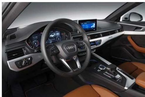
左右非対称のデザインをしたセンターコンソールには、S トロニックのセクターレバーとともに MMI のコントロールターミナルが設置されています。ターミナルはダッシュボード側に設置され、低く設定されたセクターレバーは、ドライバーがそこに手首を乗せて MMI を操作するのに、適切な形状になっています。
