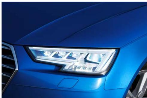
マトリクス LED ヘッドライトの照射方向調整は、ライトの焦点位置をずらすことで行っています。内蔵されているダイナミックインジケータは、一列に並べた発光ダイオードにより、内側から外側（曲がる方向）に向けた光の流れを作り出すことで、ほかの道路ユーザーに進行方向をわかりやすく示します。
