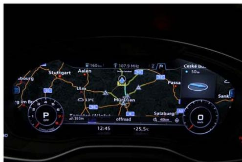
通常のメーターパネルの代わりに搭載された 1,440×540 ピクセルの解像度を持った 12.3 インチ LCD モニターに映し出される画面は非常に鮮明です。高性能プロセッサの働きにより、システムは毎秒 60 フレームのレートで緻密なアニメーションをディスプレイ上に映し出すため、例えば、仮想タコメーターの針も、とても正確で自然な動きを示します。ドライバーは、マルチファンクションステアリングホイールに設置された“View” ボタンを押すことで、バーチャルコックピットの画面表示を切り替えることができます。画面表示は基本として 2 タイプ設定されており、そのうち「インフォテイメントビュー」にすると、中央に大きなウィンドーが開いて、そこにナビゲーションマップや電話、ラジオ、オーディオなどに関するリストが表示され、タコメーターとスピードメーターが、両端の下方に丸型の計器として表示されます。もうひとつの「クラシックビュー」にすると、そうした丸型計器のサイズがアナログ
